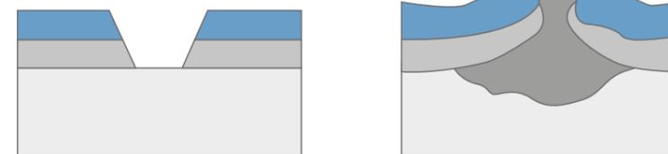
В месте повреждения сталь начинает ржаветь. Ржавчина проникает под пленку краски, приподнимает ее над стальной поверхностью. Коррозия продолжается до тех пор, пока повреждение не будет устранено.
