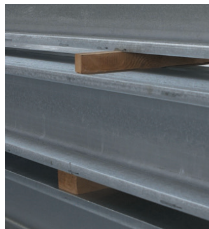
Фото 4. Деревянные вставки для обеспечения необходимой вентиляции.
