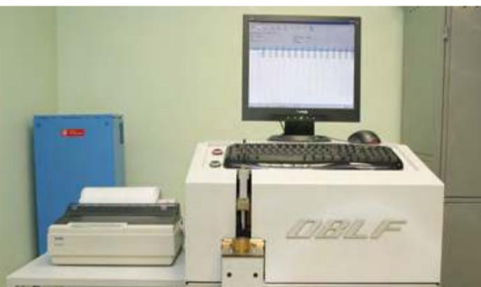
Спектрометр вакуумный эмиссионный GS 100OBLF (Германия)
